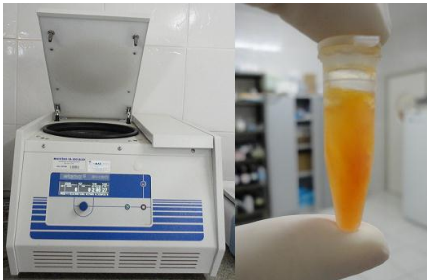
Figura 7 - Centrífuga para obtenção dos soros e microtúbos eppendorfs® para armazenamento das amostras sorológicas.
