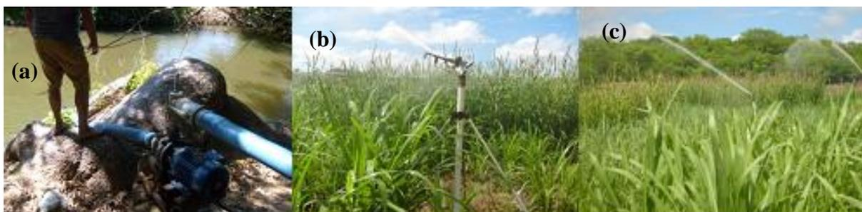
Figura 4 – a) Sistema de bombeamento; b) e c) Irrigação, utilizando aspersão convencional tipo mine-canhão.
