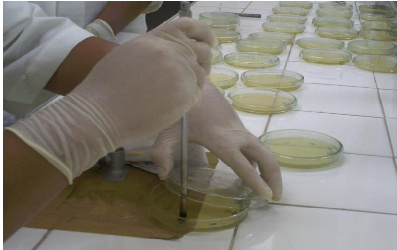
Figura 4 Perfuração dos poços com cilindro de aço inoxidável. Fonte: SANTOS, F.O., LPPN /URCA, (2009).
